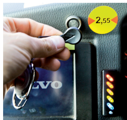
De fem lamper ved rattet fortæller hele tiden chaufføren, hvor økonomisk han eller hun kører.
